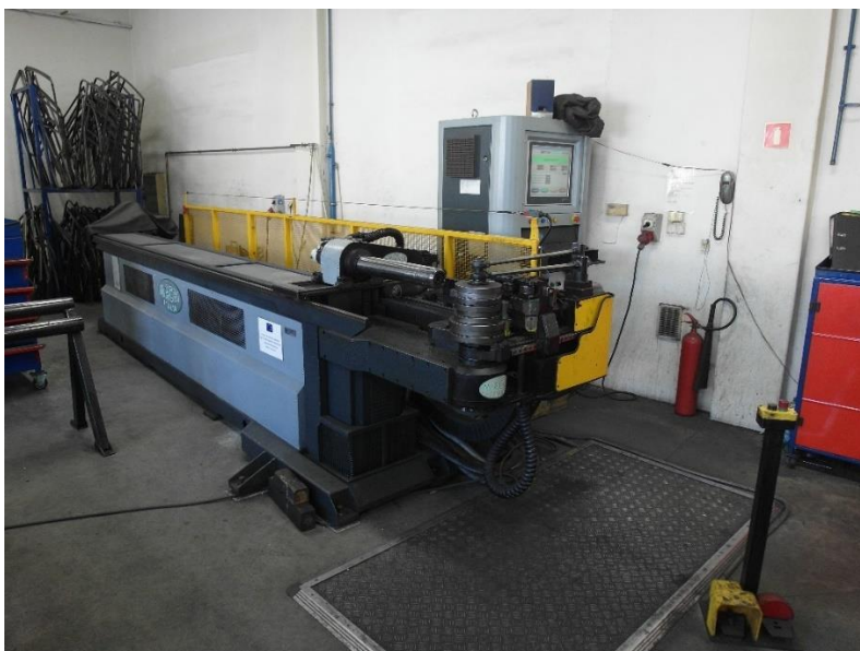
Zdjęcie 6 - Proces gięcia detali i profili
