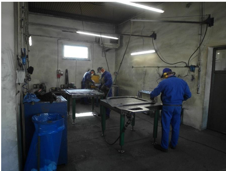
Zdjęcie 10 - Szlifowanie elementów po spawaniu
