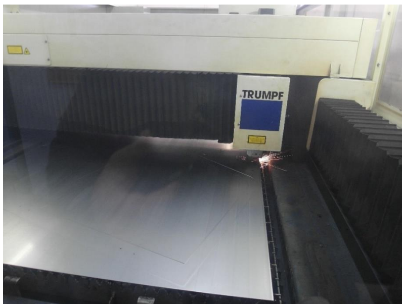
Zdjęcie 4 - Proces wypalania laserem
